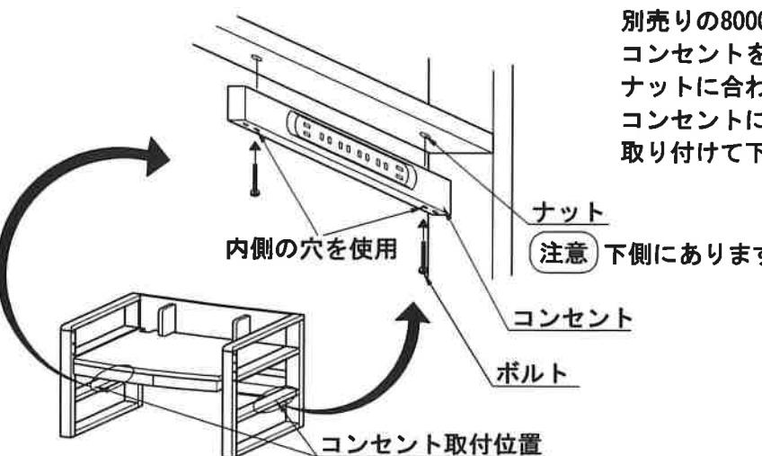
別売りの8000コンセントを取り付ける際には、コンセントを取り付位置に埋め込まれたナットに合わせ、 $\oplus$ ドライバーで、コンセントに同梱してあるボルトで取り付けて下さい。
